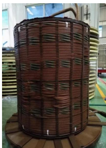
图 E.2 B 相中压绕组严重变形
