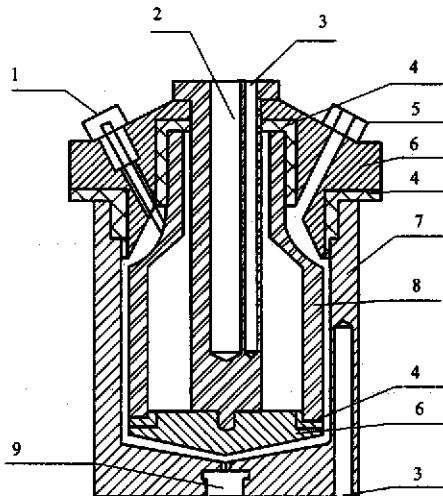
1—测量极接线端；2—内电极加热管插孔；3—测控温元件插孔；4—绝缘垫；5—进油口；
